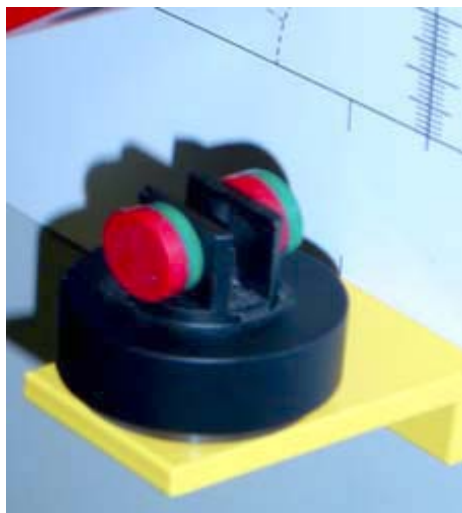
Obr. 3: Detail uchycení magnetu na přípravku pro měření.
