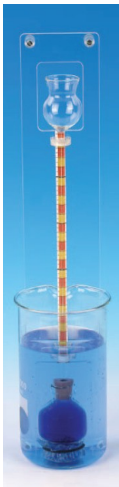
Obrázek 2: Konstrukce osmometru DM555-1A použitého při experimentu.
