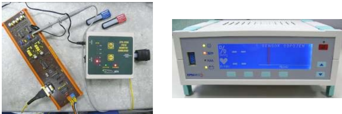
Obr. 1.2 Použití simulátoru pro analogový přípravek a pro komerční pulzní oxymetr (foto autor)
