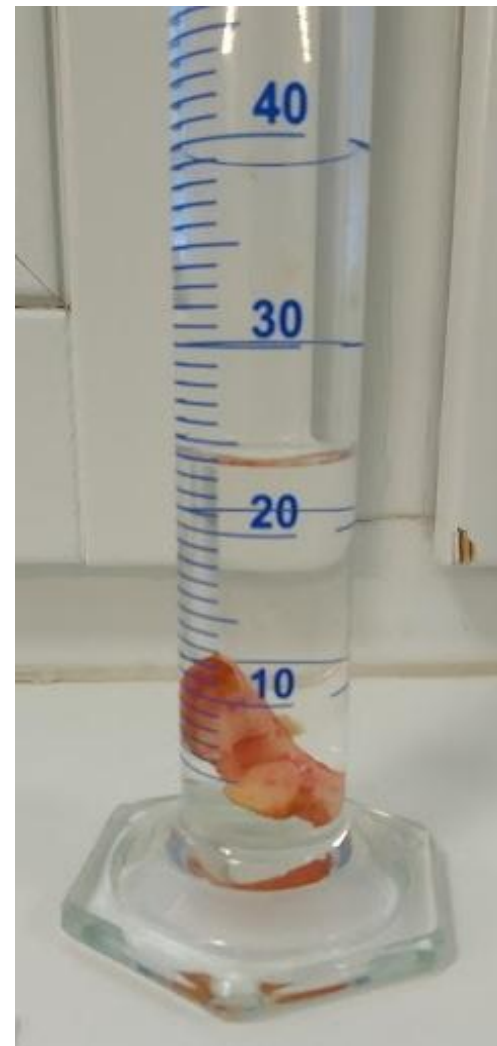
Obr. 3 a 4: Měření objemu konizátu pomocí CT systému a odměrného válce
