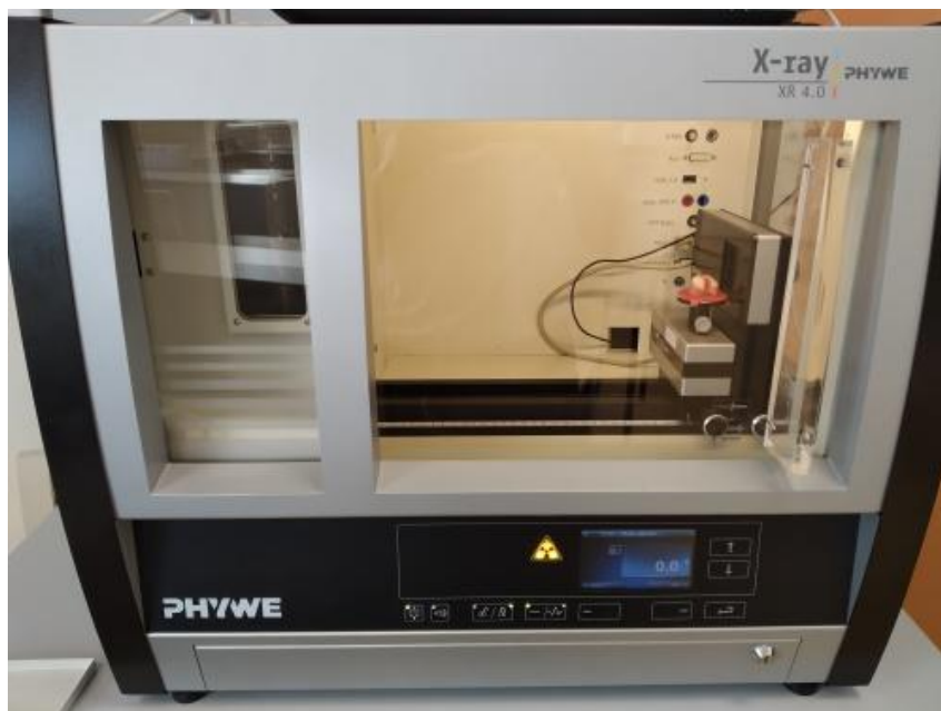
Obr. 3 a 4: Měření objemu konizátu pomocí CT systému a odměrného válce
