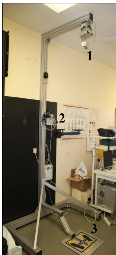
Obrázek 2.10: Systém pro určení polohy hlavy a ramen: horní kamera (1), přední kamera (2), nášlapná deska (3). Převzato z [186].
