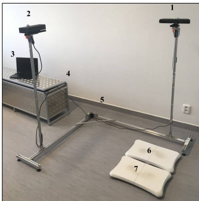
Obrázek 2.4: Systém pro měření pohybu segmentů těla a velikosti síly pod chodidly pacienta: MKV1 (1), MKV2 (2), PC (3), přepravní box (4), konstrukce systému pro upevnění MKV1, MKV2 (5), levá plošina Nintendo Wii Balance Board (6), pravá plošina Nintendo Wii Balance Board (7).
