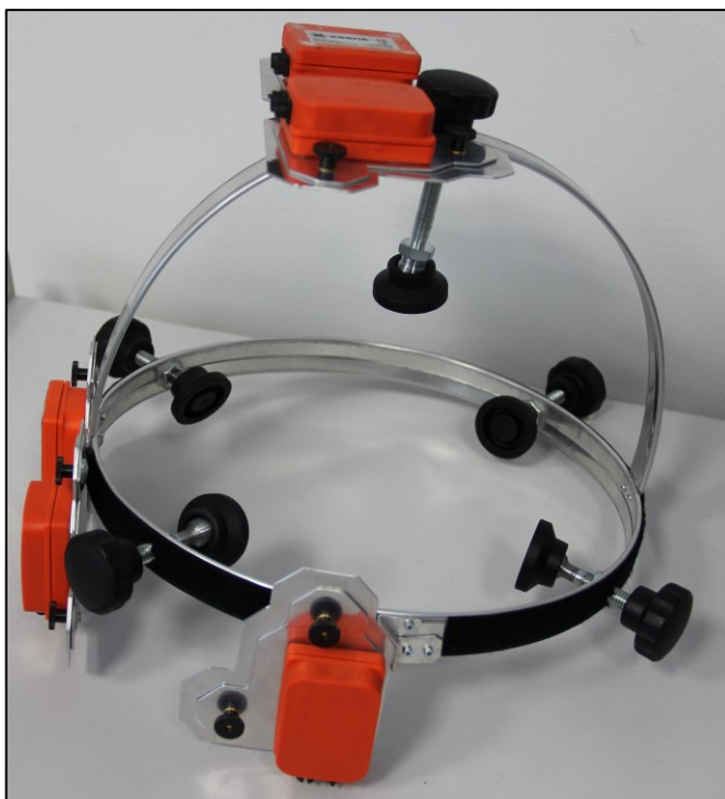
Obrázek 4.5: Upravená verze helmice zařízení pro měření pohybu labyrintů vestibulárního systému vyrobená z hliníku.
