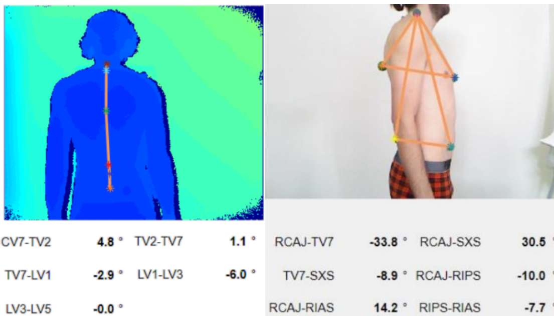
Obrázek 2.6: Výstup z kamer systému pro měření pohybu segmentů těla a velikosti síly pod chodidly pacienta – vlevo: MKV2 s vyhodnocením tvaru páteře ve frontální rovině, vpravo: MKV1 s vyhodnocením sklonu pánve a hrudníku. Převzato z [91].
