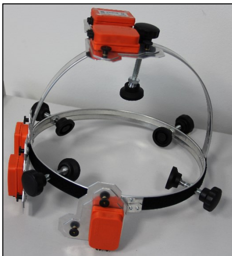
Obrázek 4.1: Helmice zařízení pro měření pohybu labyrintů vestibulárního systému vyrobená z hliníku.
