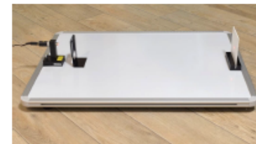
Obr. 6 – Difrakce světla přes kruhový otvor. Umístění pomůcek na magnetickém stole.
