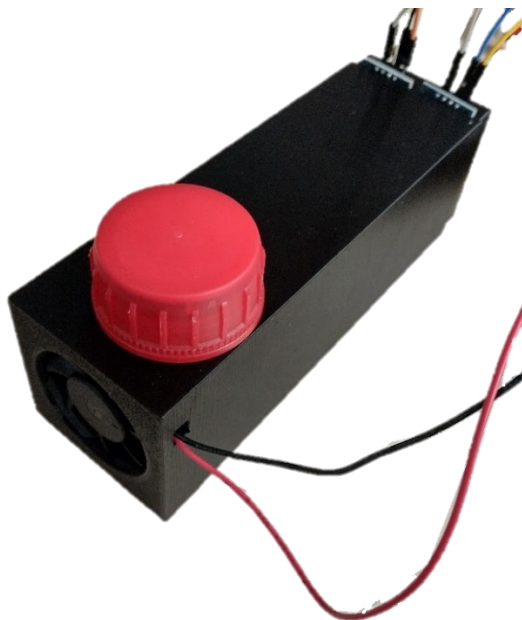
Obrázek 8: Způsob aplikace zkoumané látky pomocí víčka od nádoby
