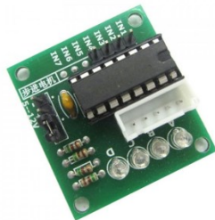
Obr. 5: Řídicí jednotka krokových motorů.
