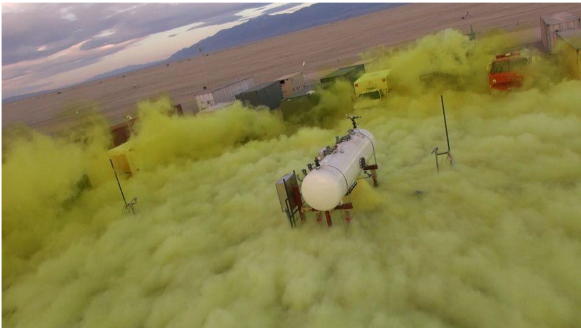
Obrázek 1: Ukázka šíření těžkého plynu, chloru, v experimentálním prostředí s patrnou první a druhou fází [62]
