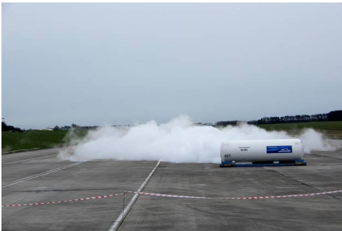
Obrázek 2: Ukázka šíření těžkého plynu, oxidu uhličitého, při úniku typu JET a tvorba viditelných oblak o vysoké koncentraci u v běžných podmínkách nepozorovatelné látky [60]
