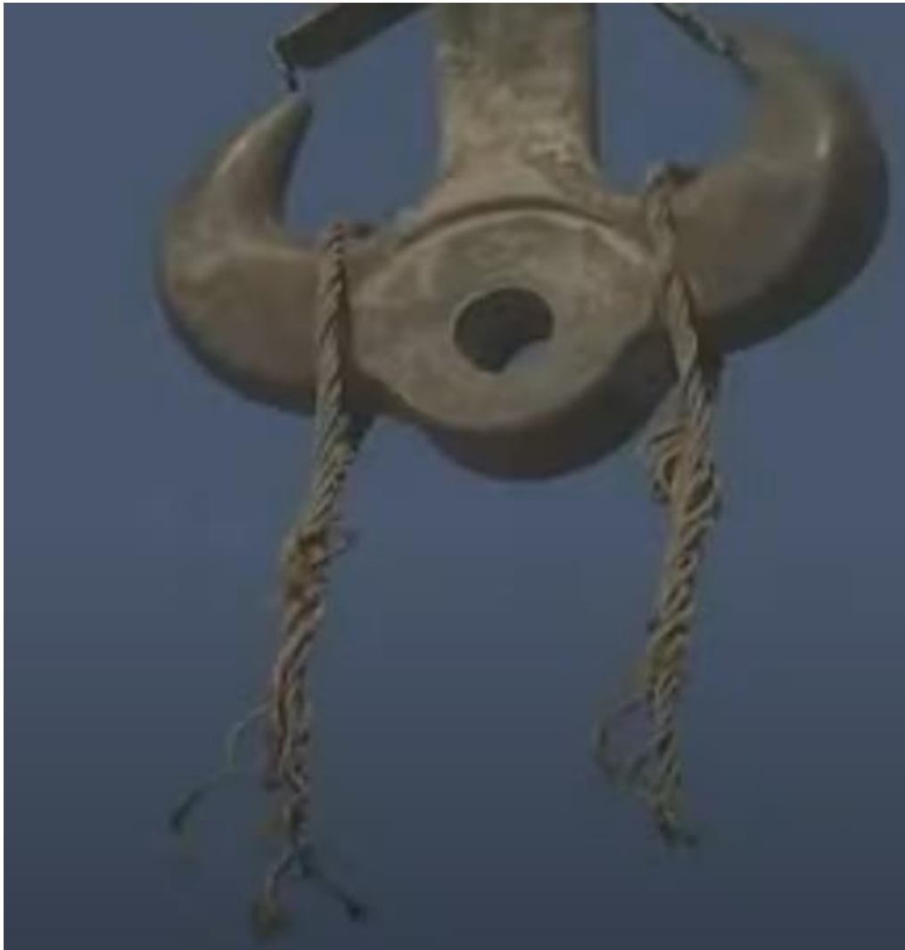
Obr. 6 Pohled na přetržené vázací prostředky (ocelová lana). [1]
