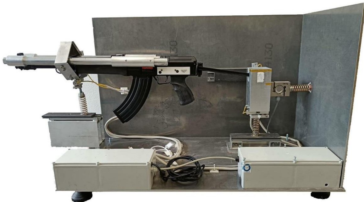
Obr. 10: Podsystem měření zpětného rázu s ukotvenou zbraní a příložným zařízením, pohled z boku. Zdroj: [7].
