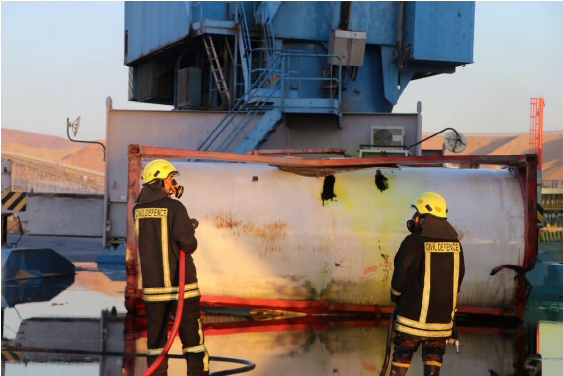
Obr. 5: Pohled na přepravní cisternu poškozenou pádem. [6]
