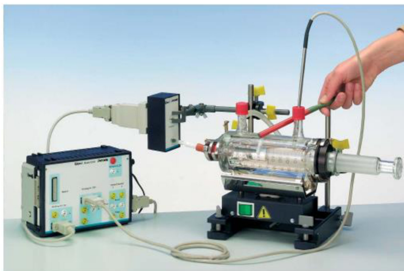
Obrázek 4. Konfigurace pro Guy-Lussacův a Charles-Amontónův zákon
