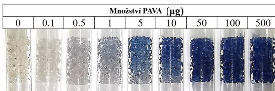
Obrázek 63 Intenzita zabarvení indikační vrstvy (0,05% Gibbsovo činidlo, 1% uhličitán sodný) v závislosti na množství PAVA (zdroj: autor).
