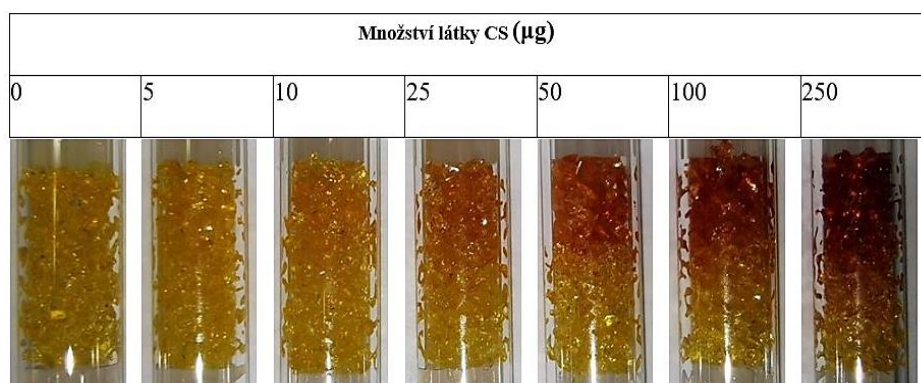
Obrázek 25 Intenzita zabarvení indikační vrstvy s 0,25% isatinem v závislosti na množství látky CS (zdroj: autor).
