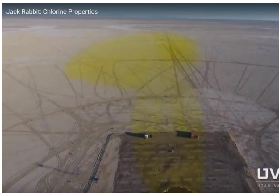
Obrázek 50 Stopa po průchodu oblaku chloru jako důsledek interakce chloru s pouštním pískem (Jack Rabbit II, 2016) [31]
