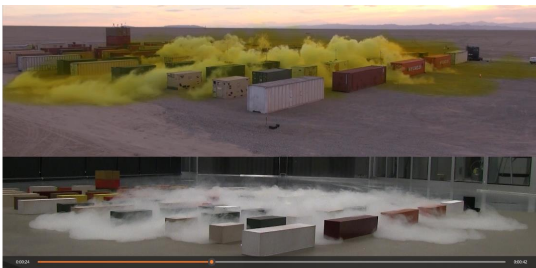
Obrázek 75 Ověření šíření chloru v urbanizovaném prostředí pomocí laboratorního experimentu za využití netoxického stopovače [74,109]
