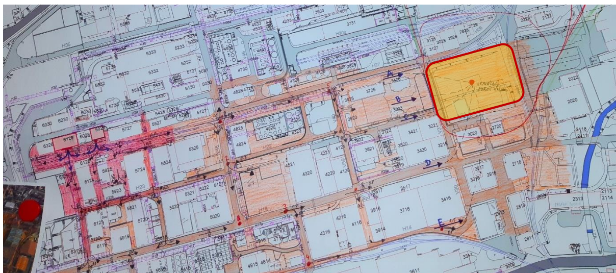
Obrázek 77 Vizualizace předpokládaného šíření oblaku chloru mezi objekty v areálu SPOLCHEMIE [zdroj vlastní]
