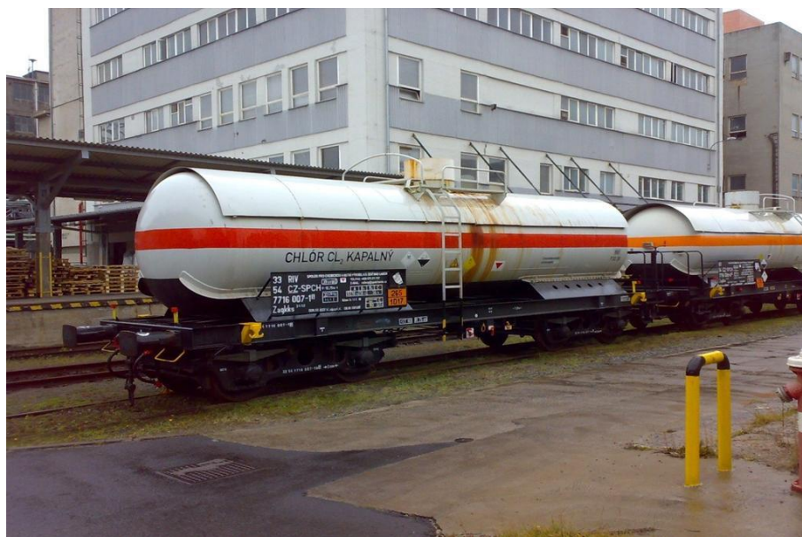
Obrázek 11 Železniční cisterna pro přepravu 66 tun kapalného chloru používaná ve SPOLCHEMIE [88]
