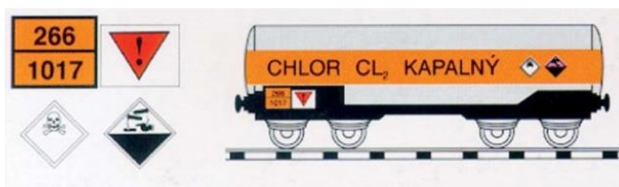
Obrázek 9 Označení železniční cisterny převážející chlor [108]
