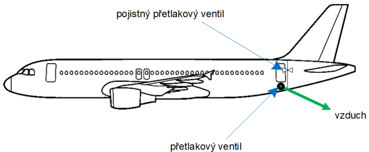
Obrázek 7 – Přetlakové ventily u letounů A 320 family
